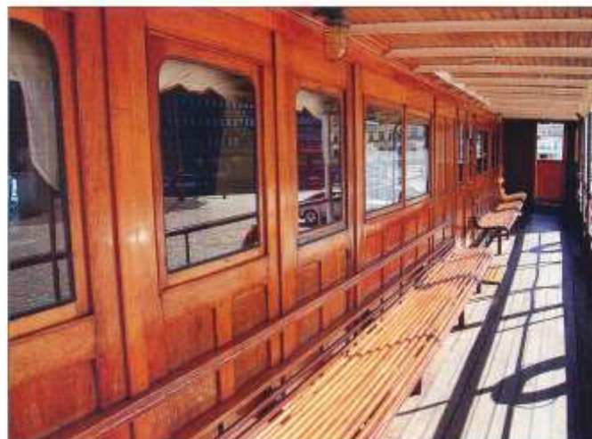
Däckshuset byggdes av teak i fyllningar och ramstycken. Styrbords promenaddäck en solig dag. Foto Bo Starmark
